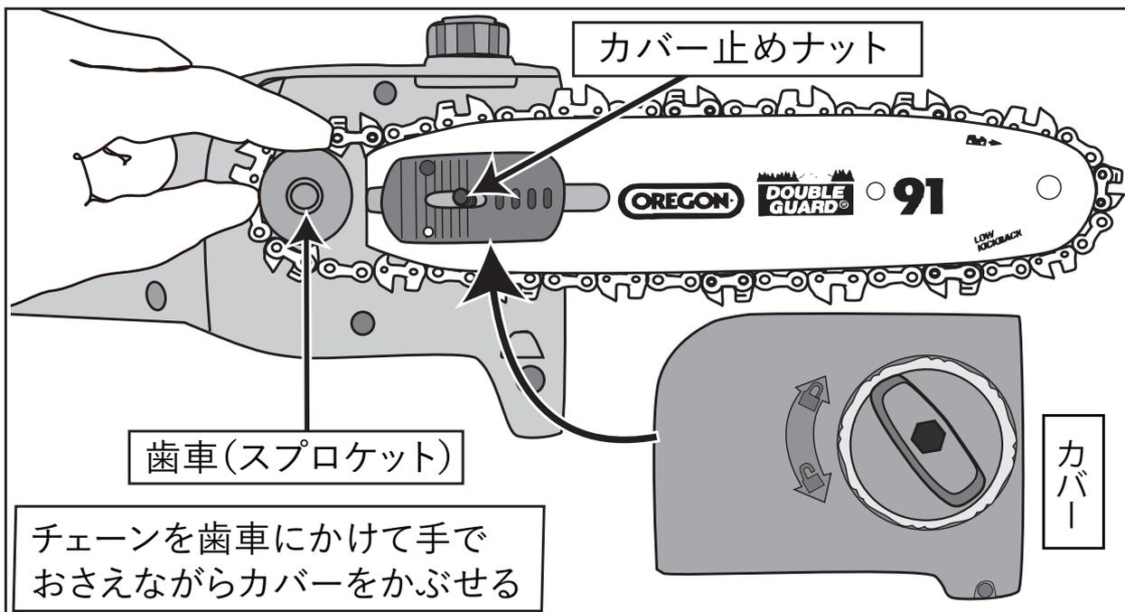
5. チェーンのたるみを先に歯車にかけて、チェーンが外れないようにガイドバーを抑えながら斜めに傾け、穴に本体側のカバー止めナットがはまるように入れます。
