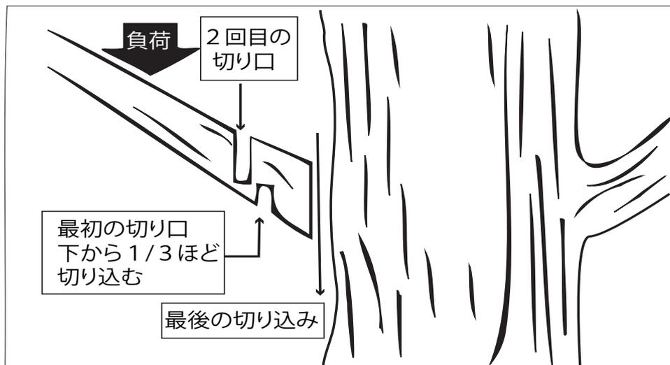
※チェーンソーを切りすすめる時は常に刃の進行方向とは逆向きに押し返す力が働きます。上側から切る時は刃を押し出ししながら、下側から切る時は引き出しながらその反発力を抑えるようにしてください。
