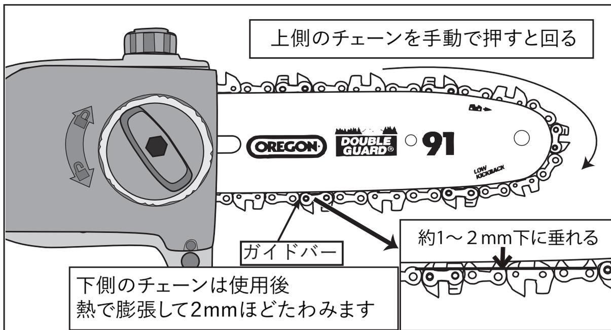
ガイドバーの下側のチェーンを軽く引っ張ってみて、ガイドバーとチェーンの間に1~2mmしか隙間が開かなければ、チェーンは正しく張られています。（使用後は熱で膨張して引っ張らなくても1~2mmはたわみます）
