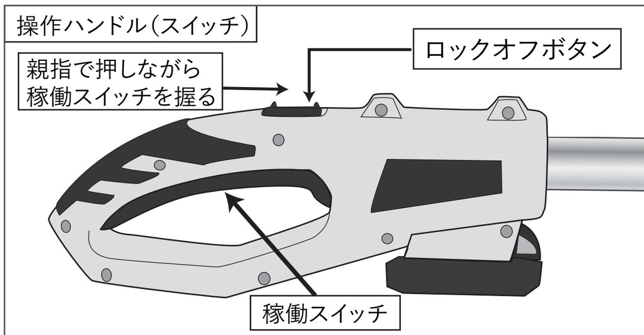
ハンドルをしっかり支え持ち、ロックオフボタンを親指で押しながら、稼働スイッチをしっかり奥まで握ります。稼働スイッチから手を離すと自動的に電源が切れます。
