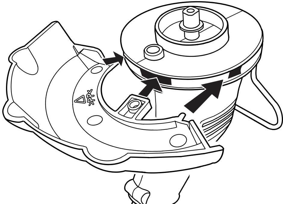
(2) 安全カバー正面の穴にカバー止め固定ネジを差し込み、締めて固定します。
