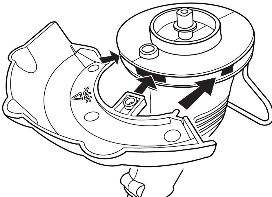
（2）安全カバー正面の穴にカバー止め固定ネジを差し込み、締めて固定します。
