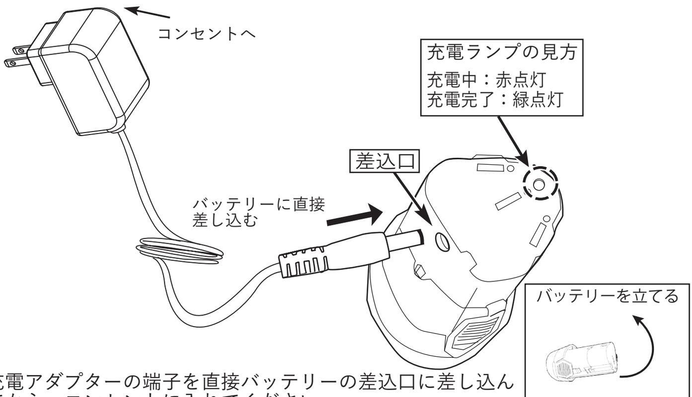
充電アダプターの端子を直接バッテリーの差込口に差し込んでから、コンセントに入れてください。
