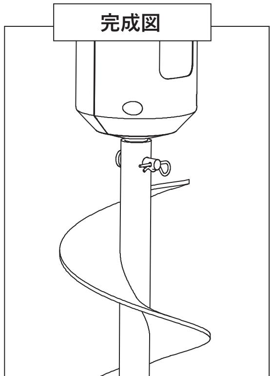
※ドリルはドリルアタッチメントを別のサイズに変えることで掘り進められる穴の作業幅が変わります。より大きい穴を掘削したい場合は、別売のアタッチメントに取り替えてご使用ください。
