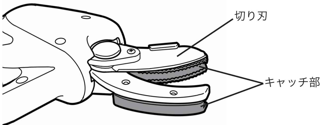
キャッチ機能を使いたい時は、常にハサミに向かって左側に収穫したい枝先がくるように切断してください。
