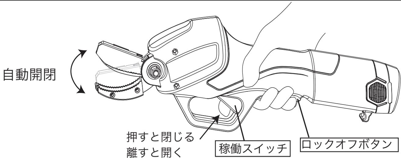
**スイッチの操作方法：**スイッチは不用意に入らないように、ロックオフボタンを入れてから稼働スイッチを押すダブルスイッチ方式になっています。
